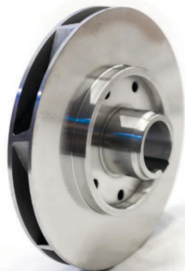
Закрытые рабочие колеса расположены в корпусе каждой ступени; они стандартно выполнены из дуплексной нержавеющей стали CD4MCu, характеризующейся высокой устойчивостью к износу и коррозии.
